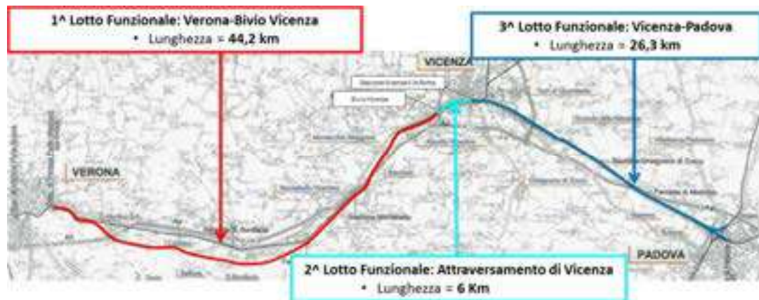
Figura 15 – Tratta AV/AC Verona-Padova: attuale configurazione progettuale
